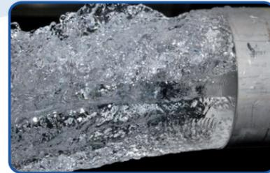
Figure 9 : Photographie d'un jet collé
